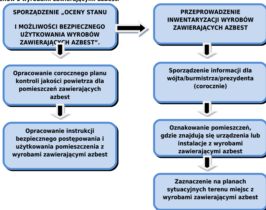
Rysunek 1. Schemat procedury dotyczącej obowiązków i postępowania właścicieli i zarządców przy użytkowaniu obiektów i terenów z wyrobami zawierającymi azbest.
