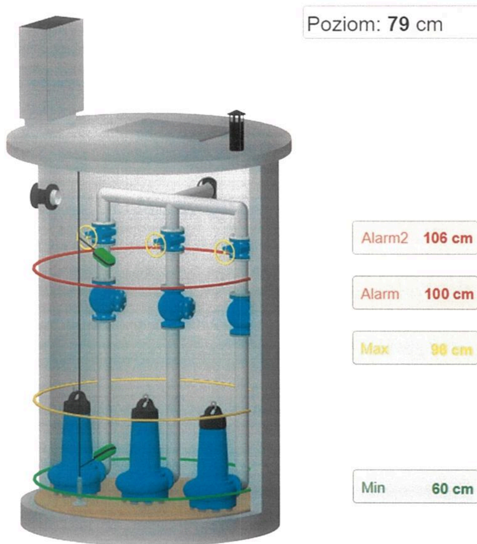
Rysunek 2. Przepompownia trzypompowa.
